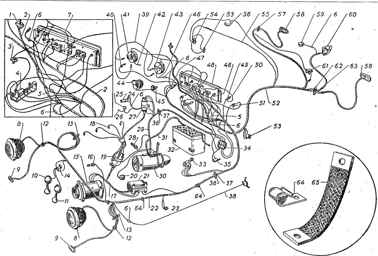
Фиг. 62. Схема электрооборудования автомобиля:
