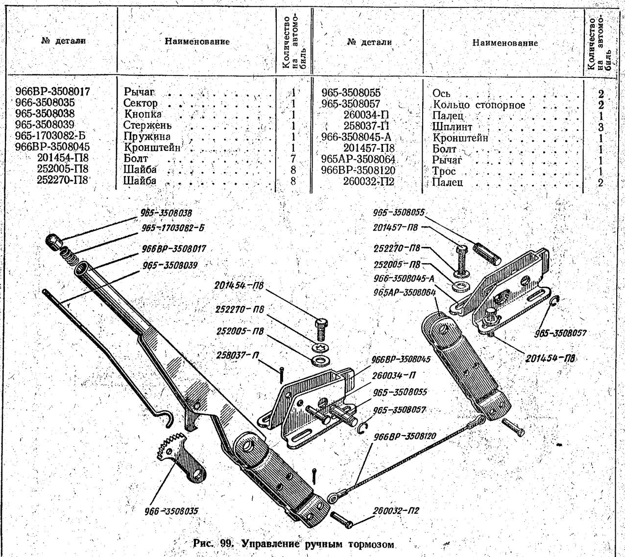
Рис. 99. Управление ручным тормозом.
