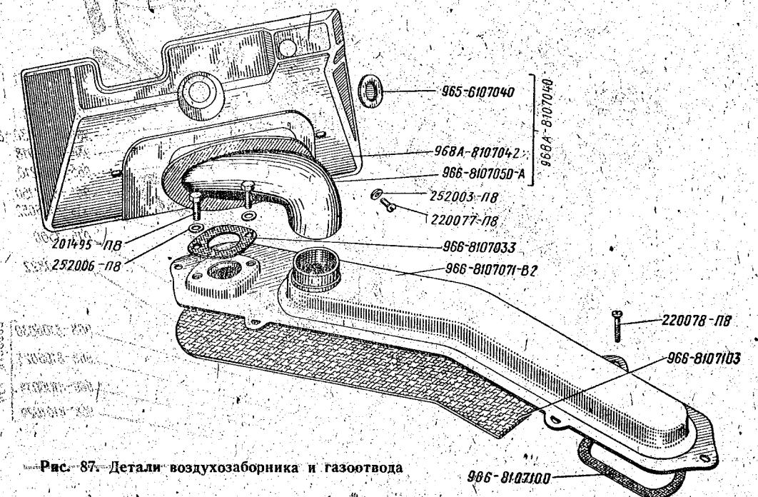
Рис. 87. Детали воздухозаборника и газоотвода
