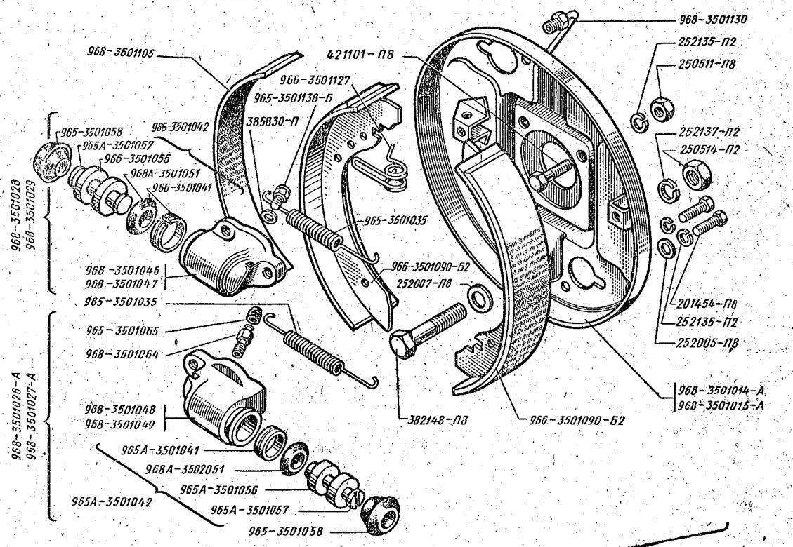
Рис. 50. Передний рабочий тормоз
