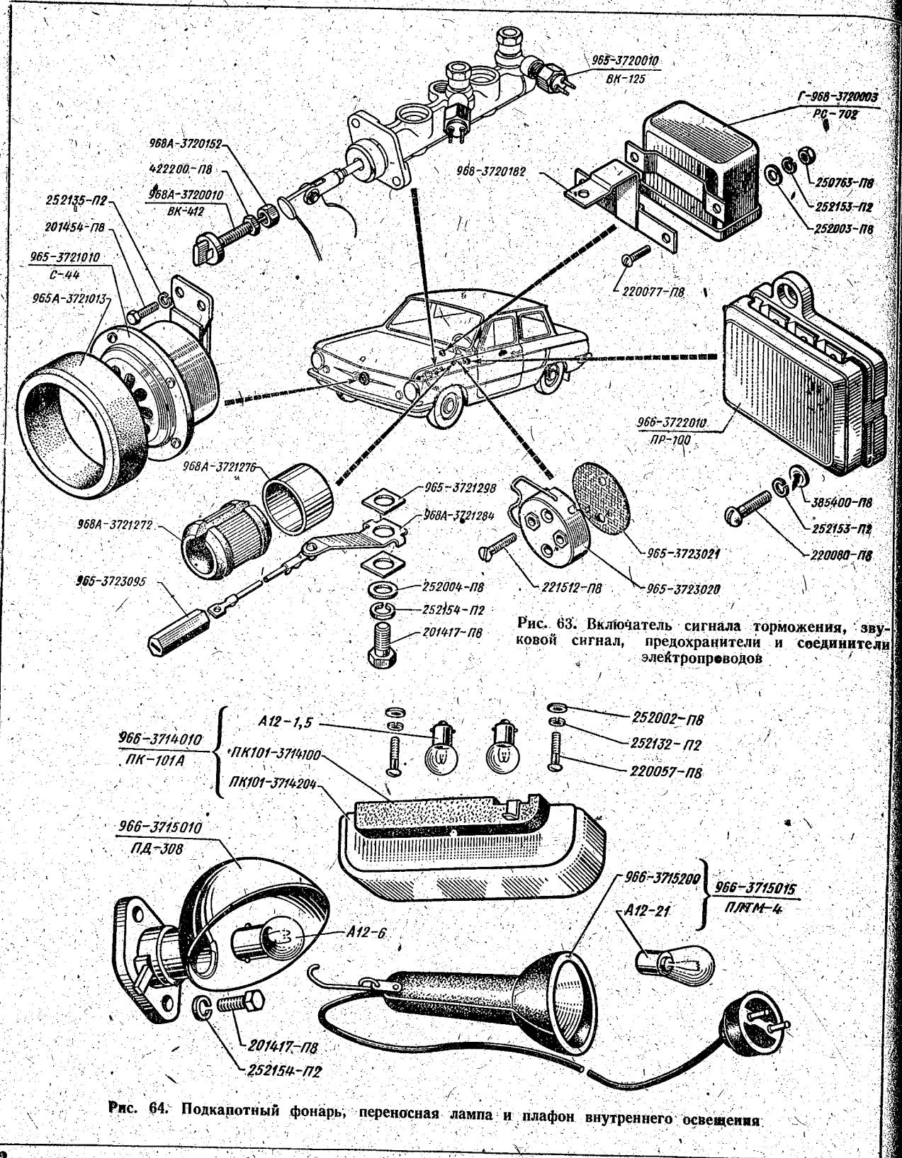
Рис. 64. Подкапотный фонарь, переносная лампа и плафон внутреннего освещения.
