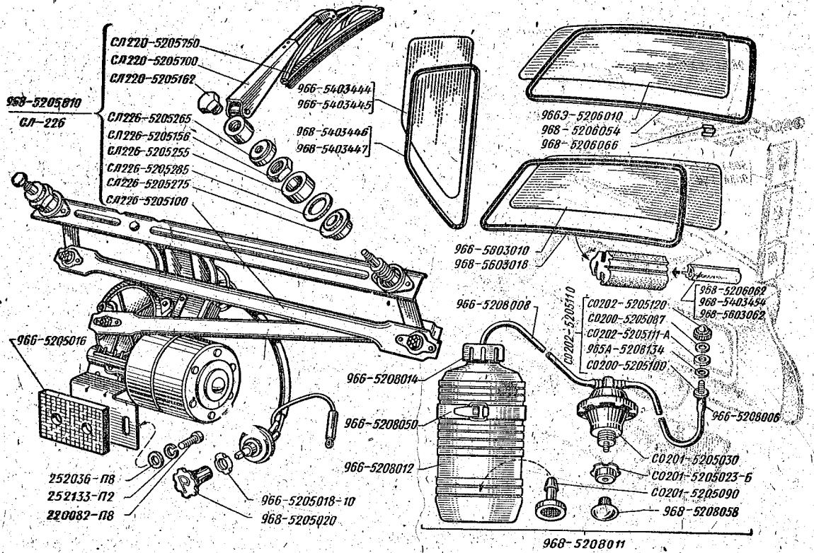
Рис. 71. Стекла и уплотнители, стеклоочиститель и смыватель с ветрового стекла
