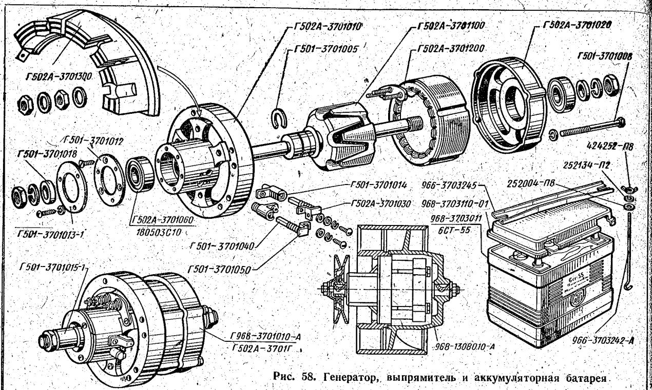
Рис. 58. Генератор, выпрямитель и аккумуляторная батарея.
