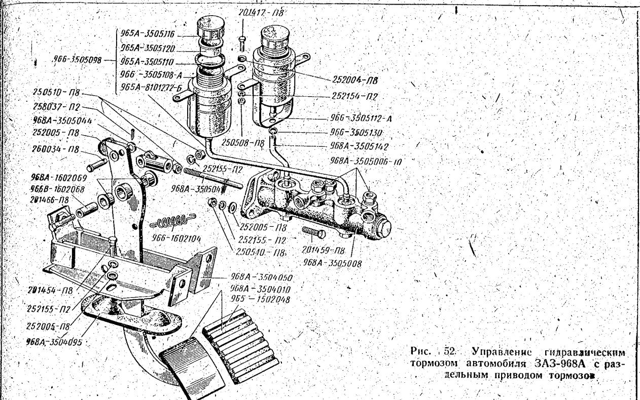
Рис. 52. Управление гидравлическим тормозом автомобиля ЗАЗ-968А с раздельным приводом тормозов
