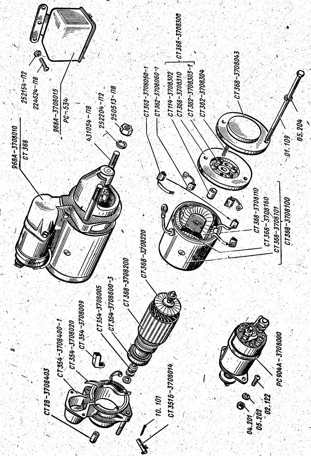
Рис. 60. Стартер и реле стартера
