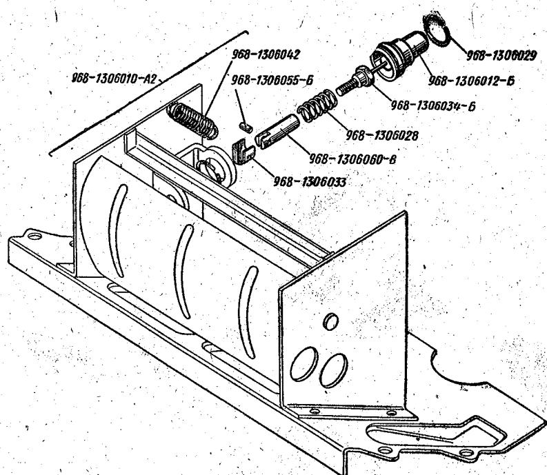
Рис. 24. Терморегулятор
