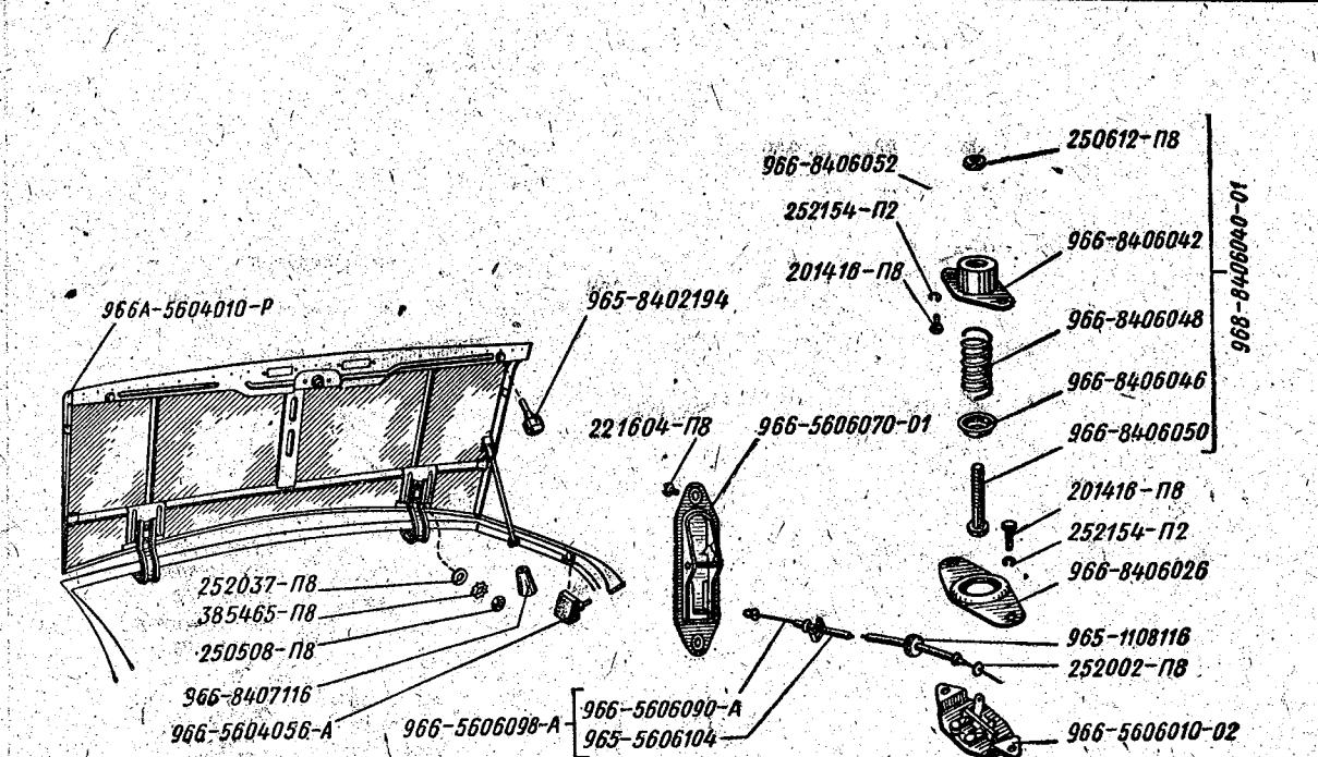
Рис. 76. Капот задка и замок капота
