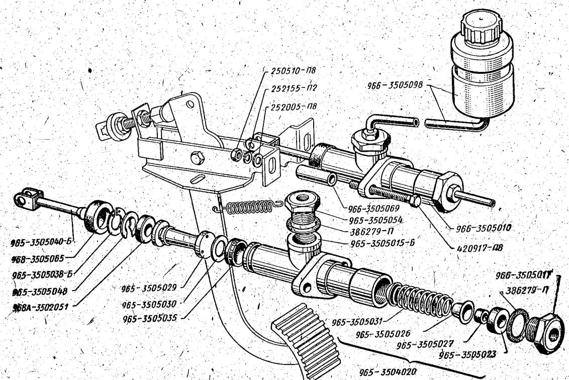
Рис. 53. Управление гидравлическим тормозом и детали главного цилиндра тормоза автомобиля ЗАЗ-968
