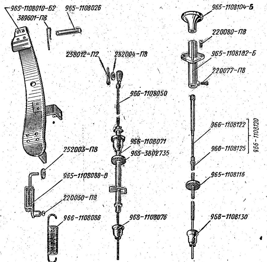
Рис. 22. Управление подачей топлива
