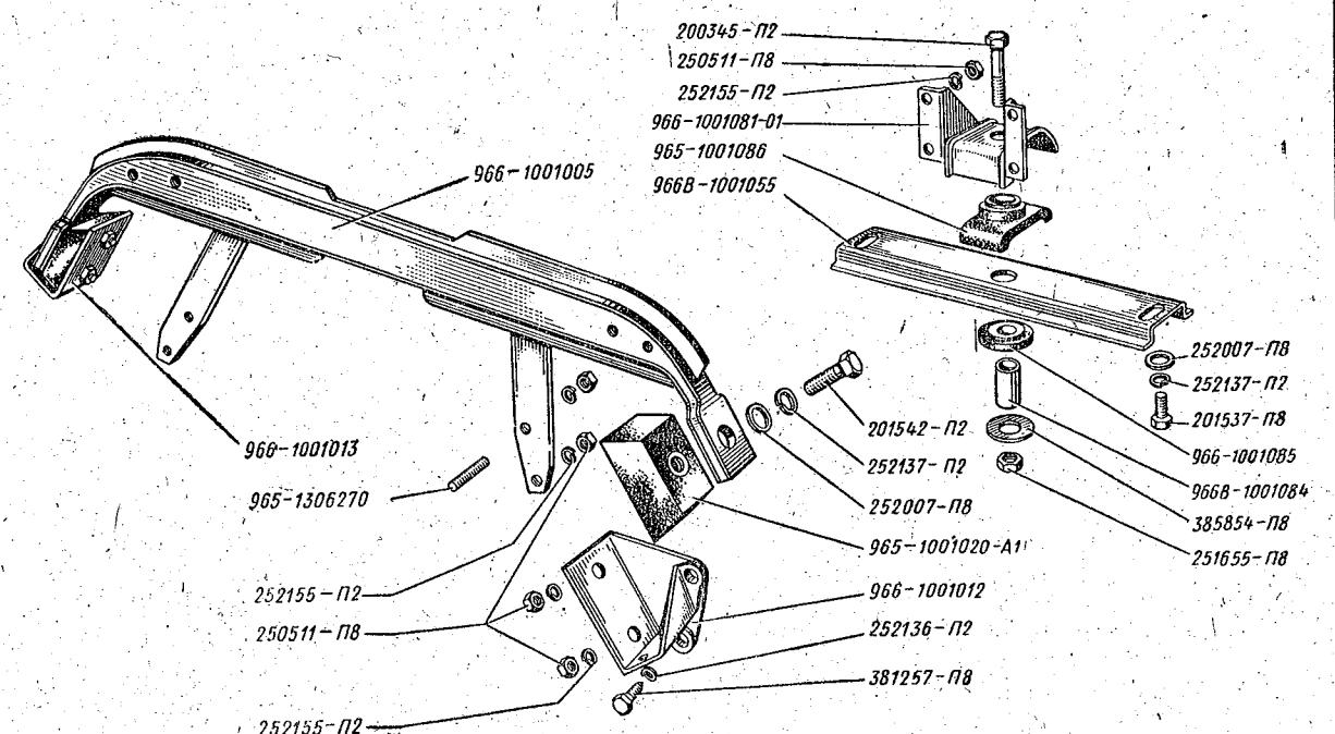
Рис. 6. Детали подвески силового агрегата
