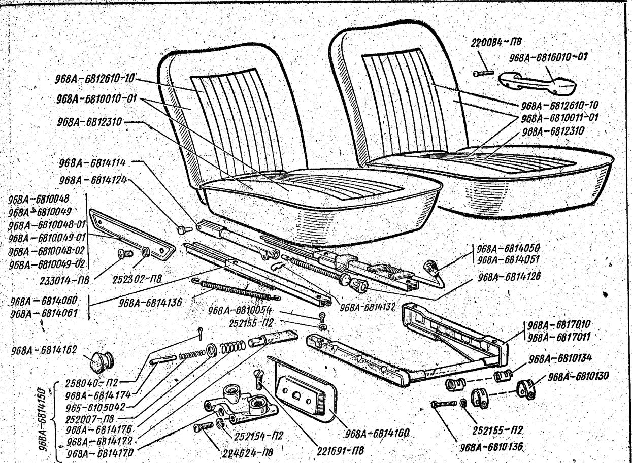
Рис. 82. Передние сиденья, механизм регулирования положения переднего сиденья и подлокотники
