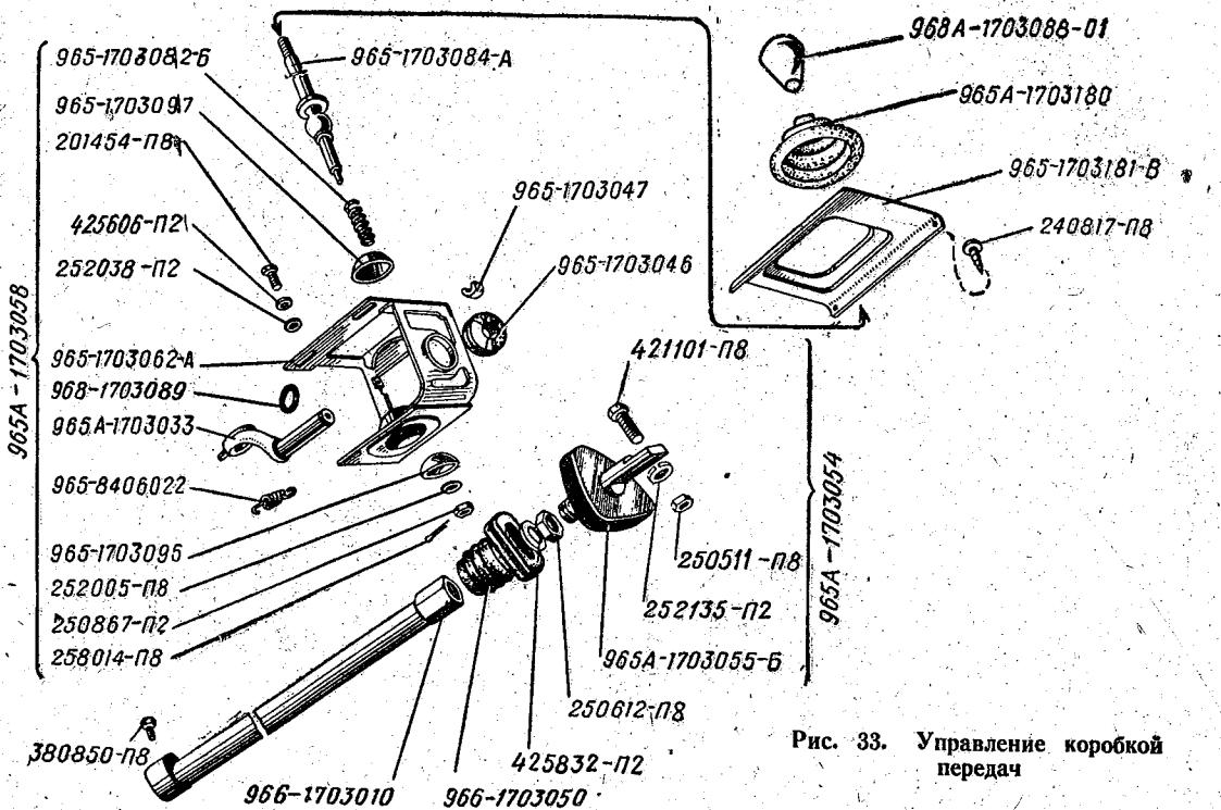
Рис. 33. Управление коробкой передач
