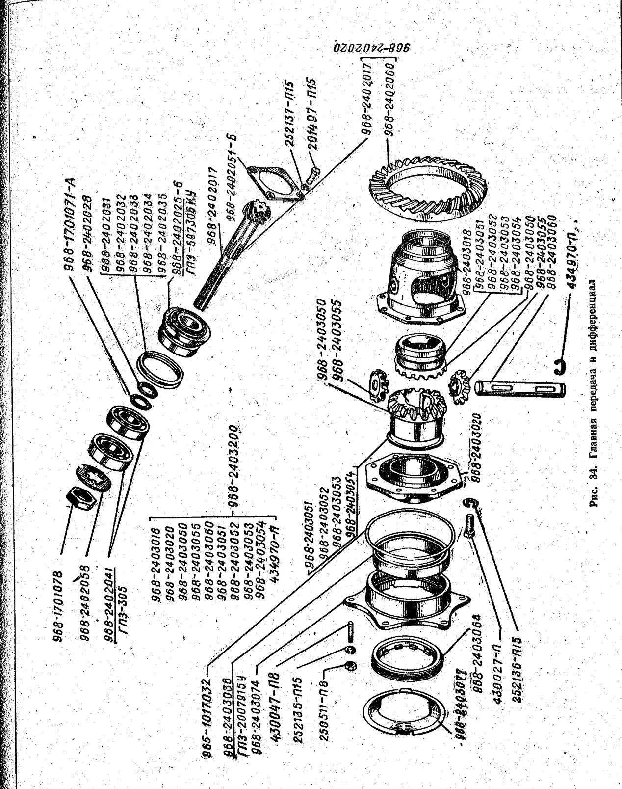
Рис. 34. Главная передача и дифференциал
