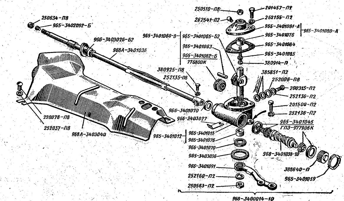
Рис. 49. Механизм рулевого управления
