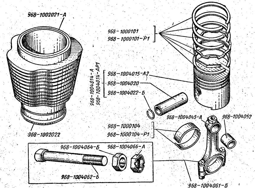
Рис. 9. Поршень, шатун, цилиндр
