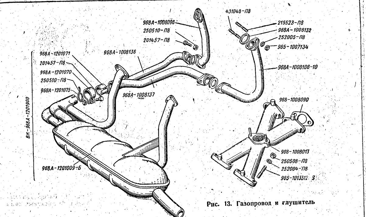
Рис. 13. Газопровод и глушитель
