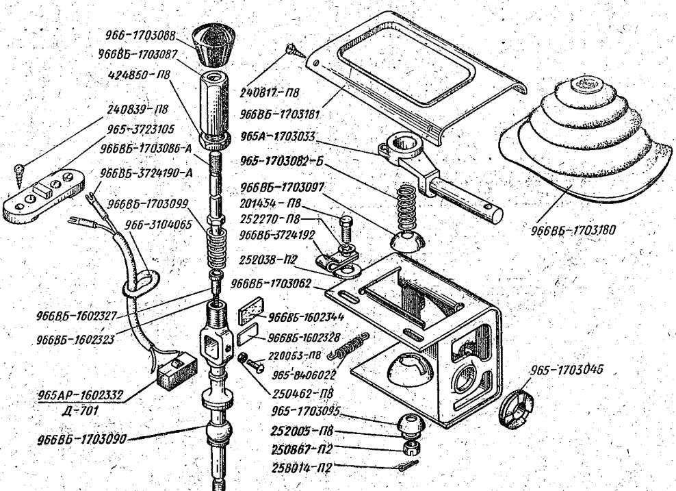
Рис. 95. Привод выключения сцепления и привод управления механизмом переключения передач (автомобили ЗАЗ-968Б)
