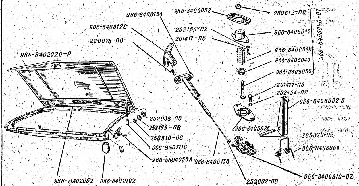
Рис. 91. Капот багажника и замок капота
