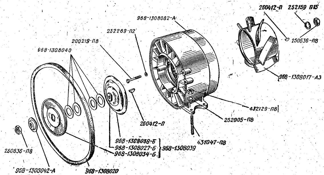
Рис. 25. Вентилятор и его привод
