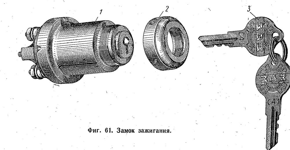
Фиг. 61. Замок зажигания.
