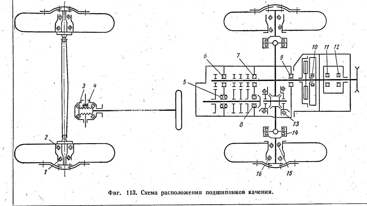
Фиг. 113. Схема расположения подшипников качения.
