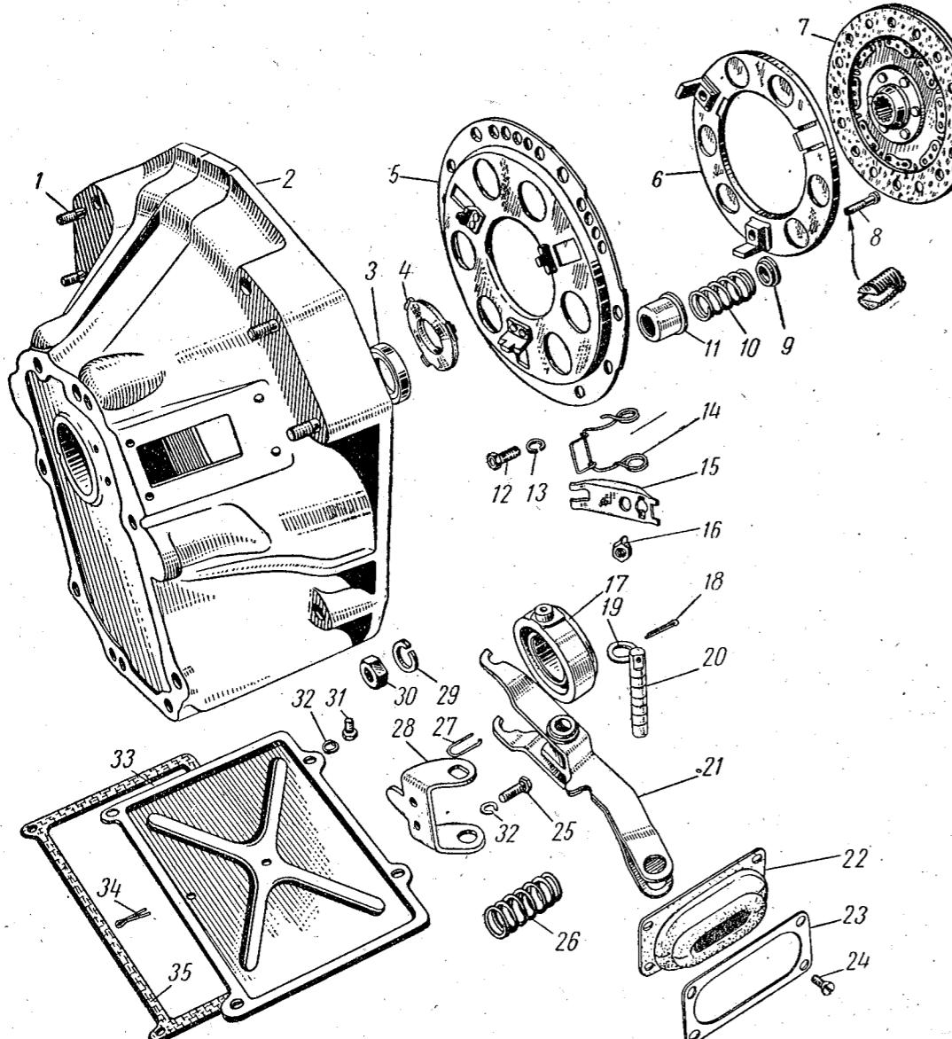
Фиг. 25. Механизм сцепления.
