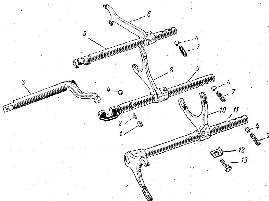
Фиг. 31. Механизм переключения коробки передач.
