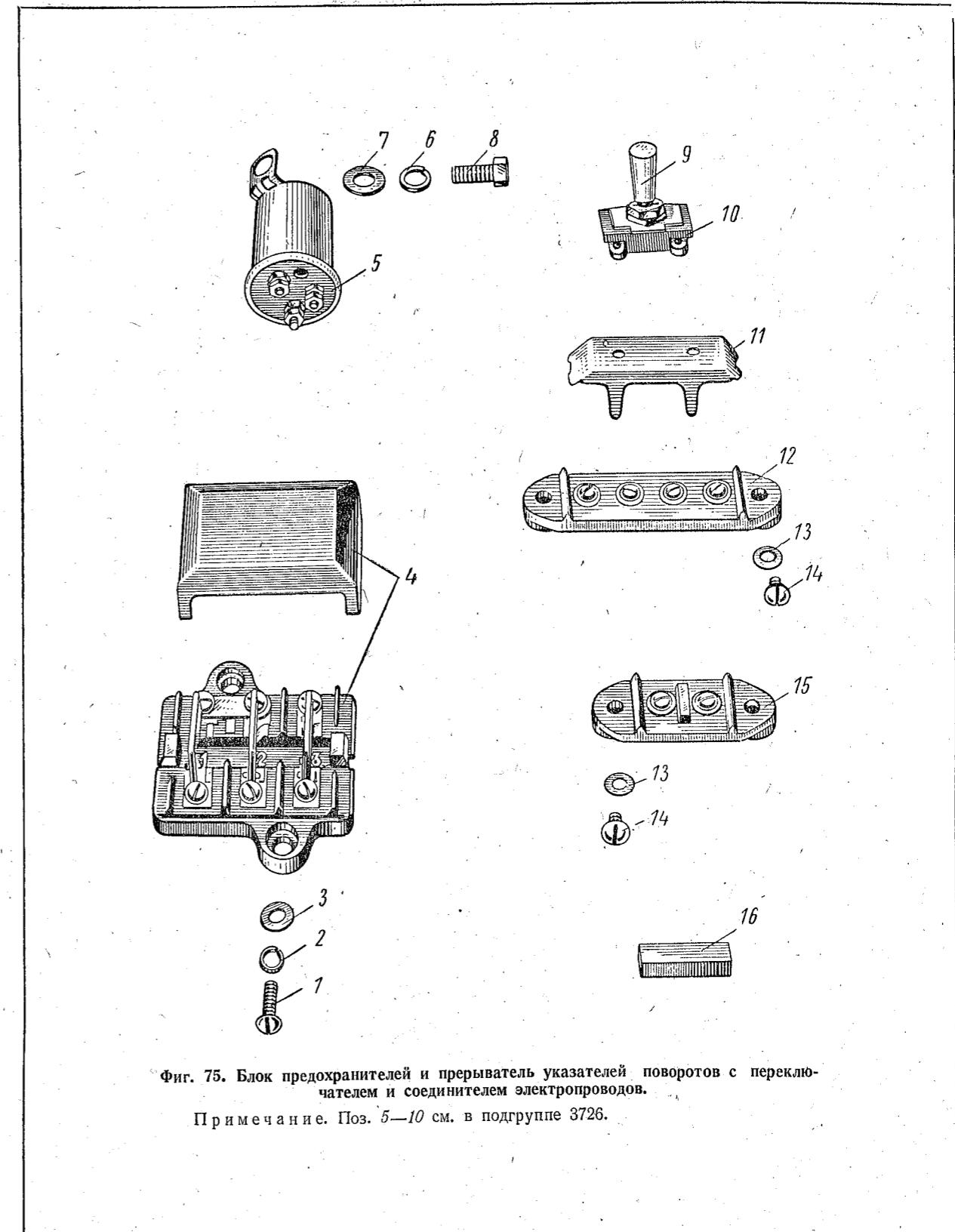
Фиг. 75. Блок предохранителей и прерыватель указателей поворотов с переключателем и соединителем электропроводов.
