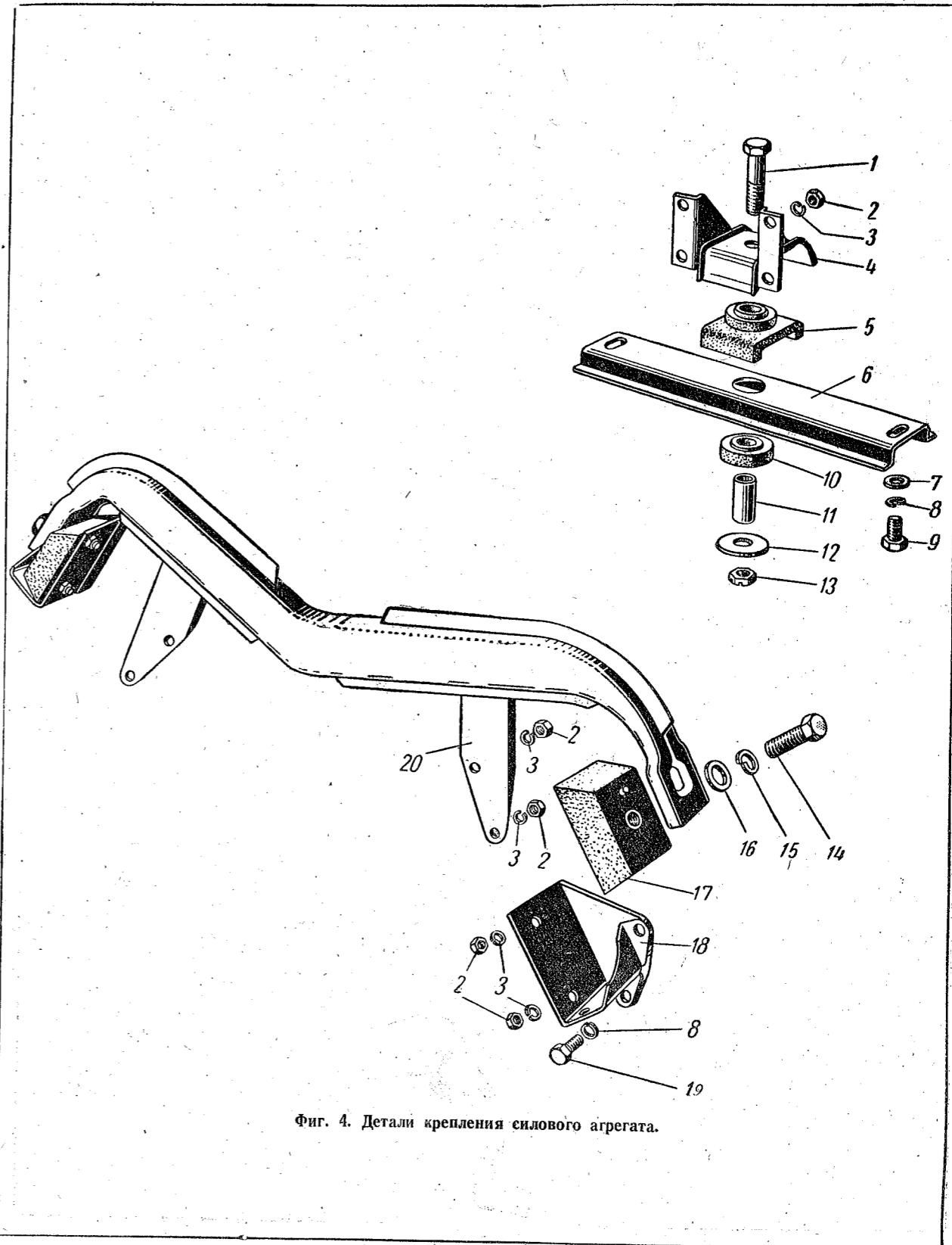
Фиг. 4. Детали крепления силового агрегата.
