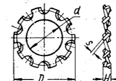
**Шайбы пружинные зубчатые конические**
