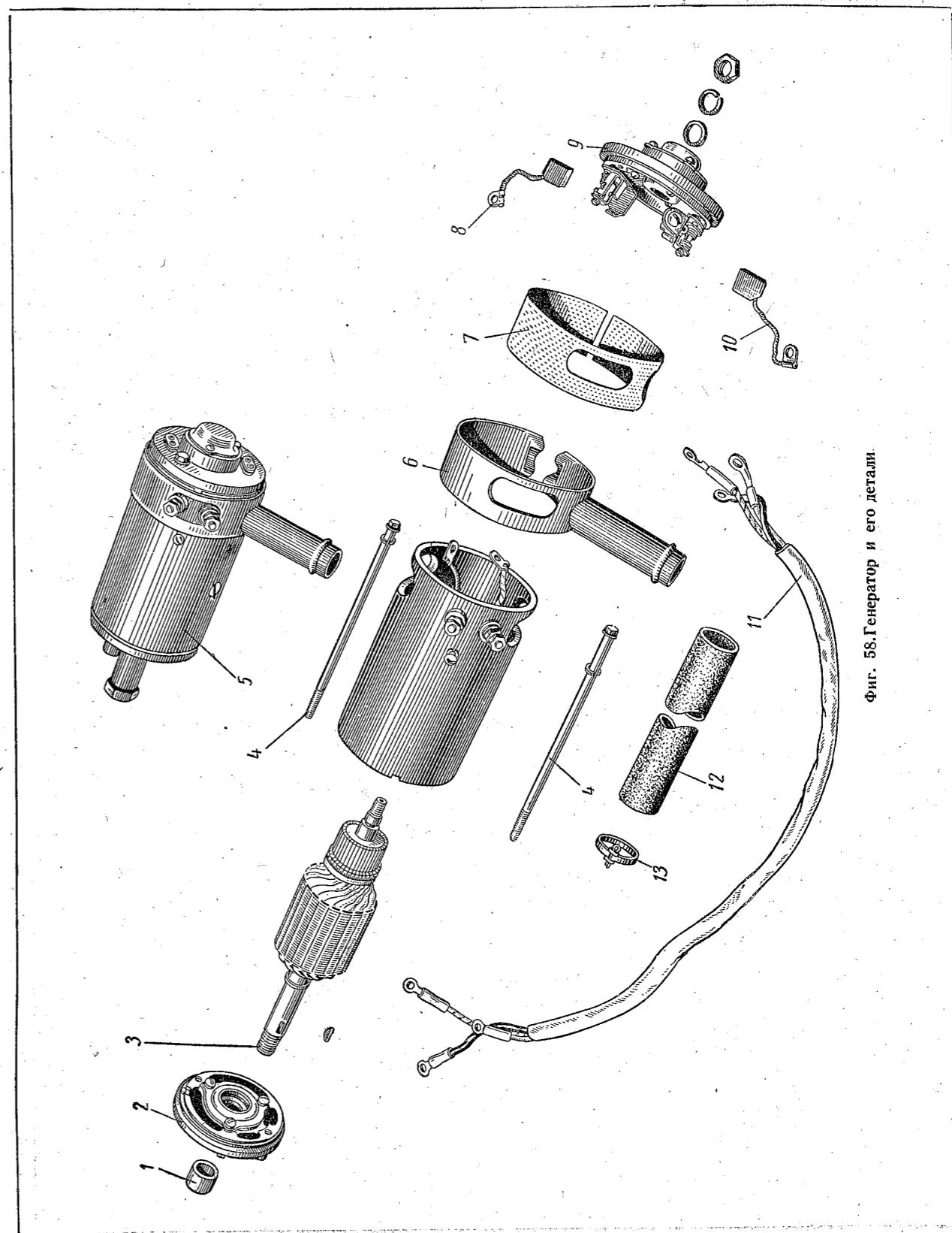
Фиг. 58. Генератор и его детали.
