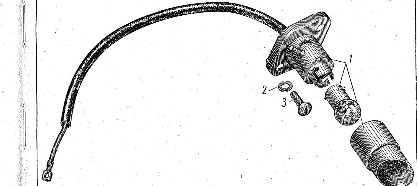
Фиг. 70. Подкапотный фонарь.
