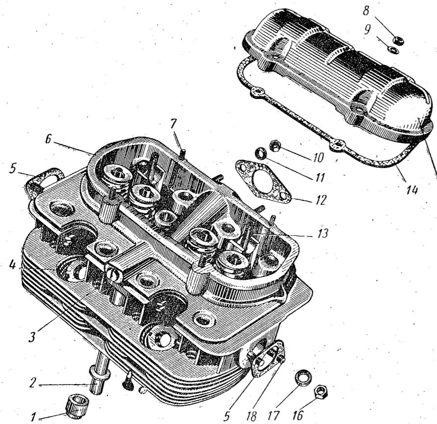
Фиг. 6. Головка цилиндров.
