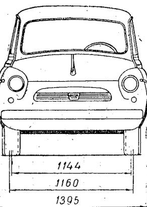
Фиг. 2. Схема автомобиля «Запорожець» модели ЗАЗ-965А.
