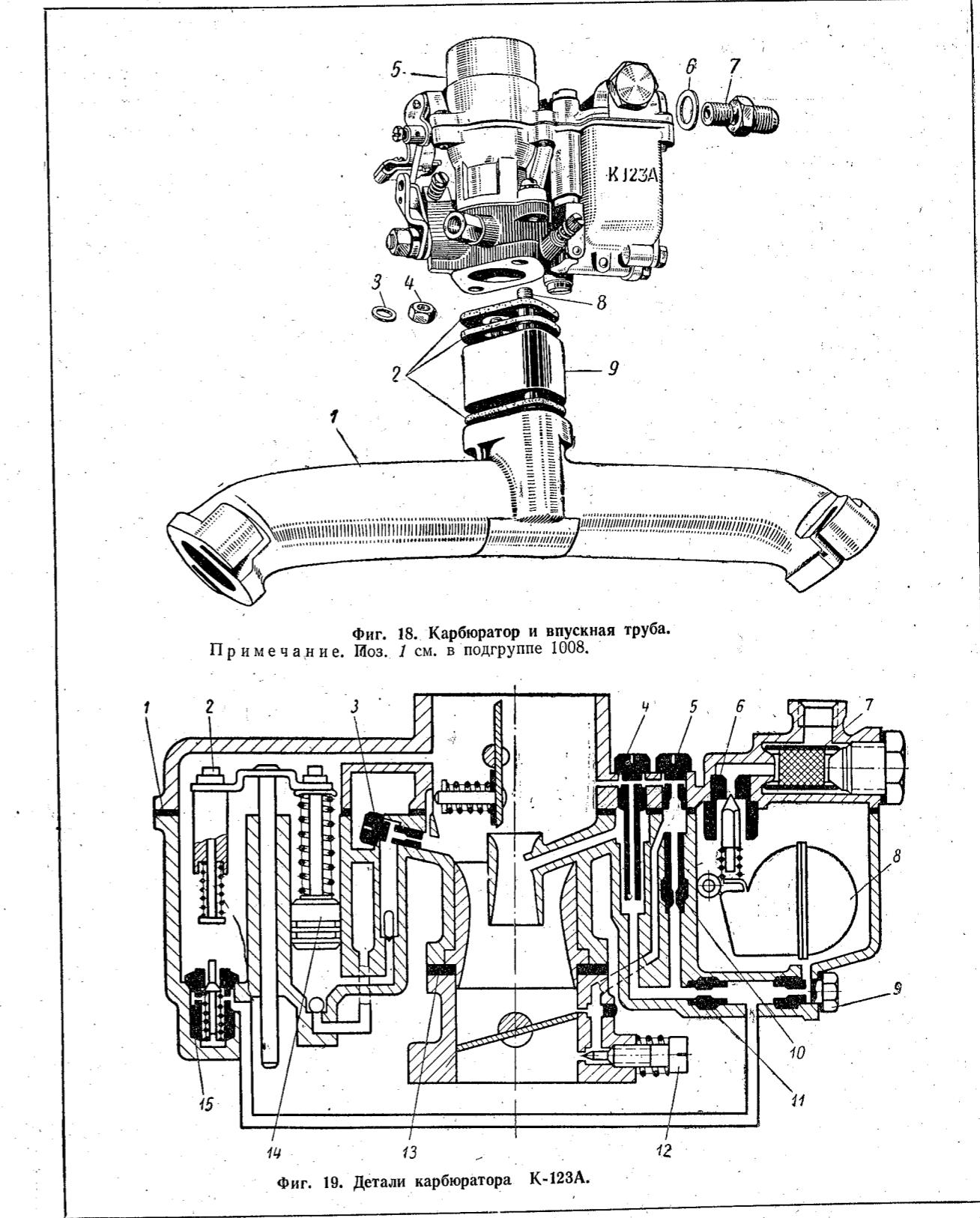
Фиг. 19. Детали карбюратора К-123А.
