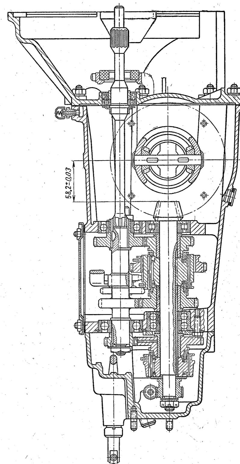
Фиг. 28. Коробка передач (разрез).
