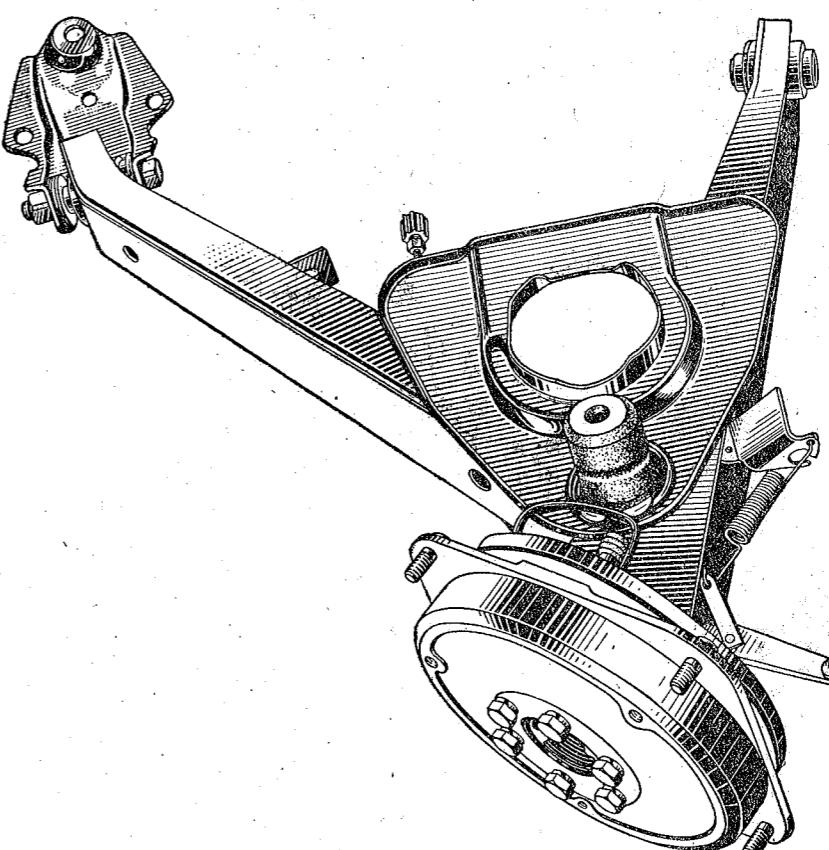
Фиг. 37. Рычаг задней подвески с тормозом в сборе.
