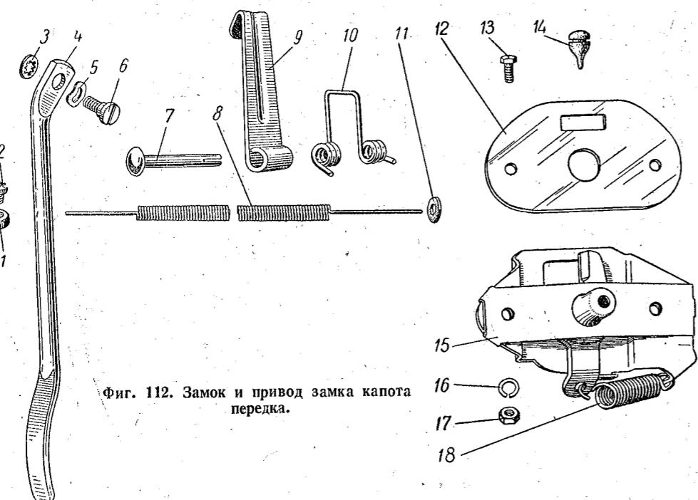
Фиг. 112. Замок и привод замка капота передка.
