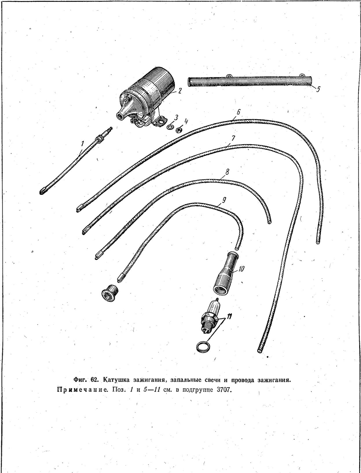
Фиг. 62. Катушка зажигания, запальные свечи и провода зажигания.
