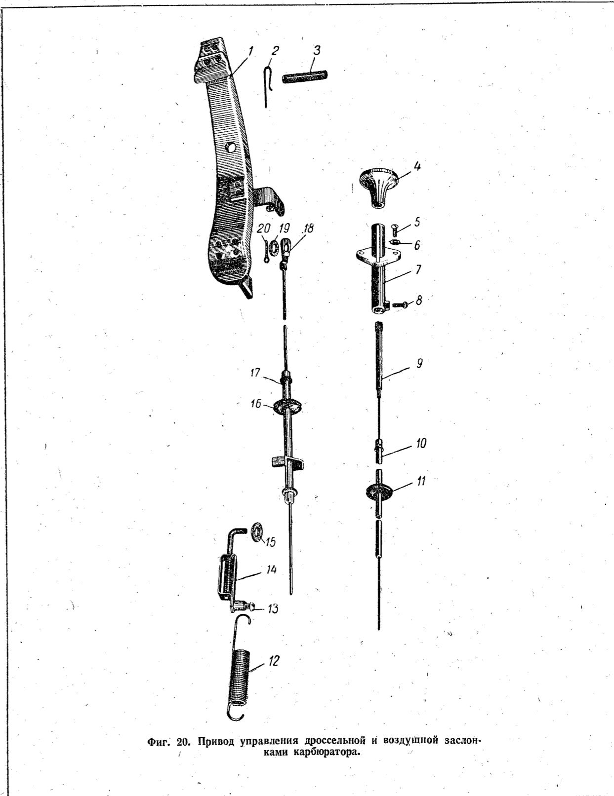
Фиг. 20. Привод управления дроссельной и воздушной заслонками карбюратора.
