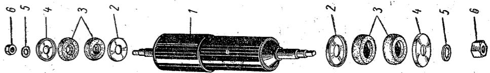
Фиг. 44. Амортизаторы задней подвески.
