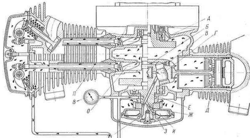
Рис. 12. Схема смазки двигателя:
