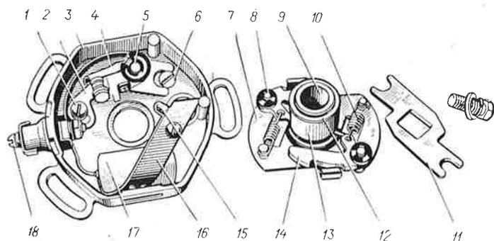
Рис. 10. Прерыватель ПМ302А с автоматом опережения:
