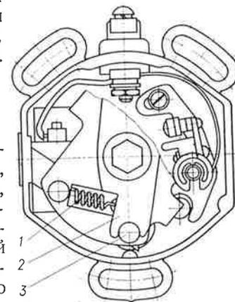
Рис. 11. Установка поводка на автомат опережения зажигания ПМ302А:
