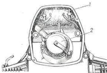
Рис. 36. Катушка зажигания и прерыватель с автоматом опережения зажигания:
