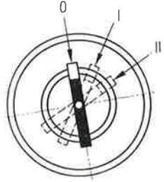
Рис. 3. Положение ключа замка зажигания
