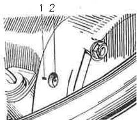
Рис. 9. Расположение меток на карте двигателя и маховика:
