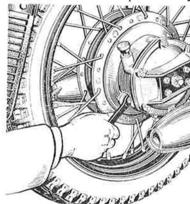
Рис. 30. Регулирование тормоза заднего колеса
