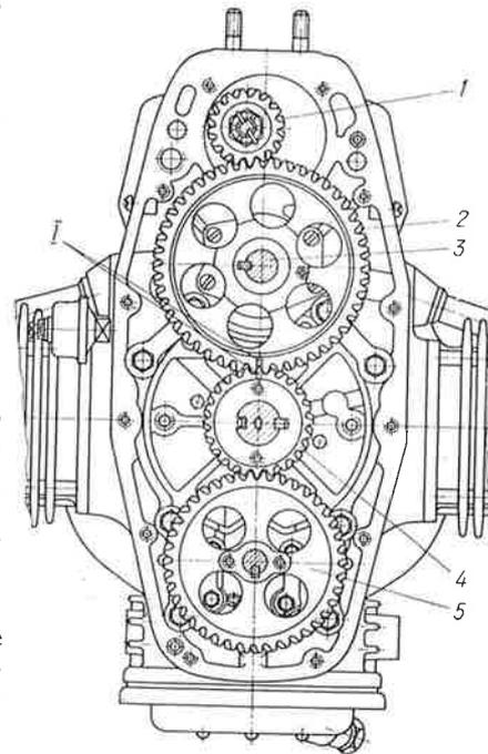
Рис. 8. Шестерни двигателя: 1 — шестерня генератора; 2 — шестерня распределительного вала ведомая; 3 — вал распределительный; 4 — шестерня распределительная ведущая; 5 — шестерня привода масляного насоса; 1 — метки
