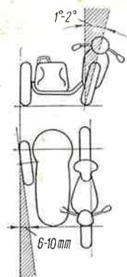
Рис. 32. Схема установки схождения колес
