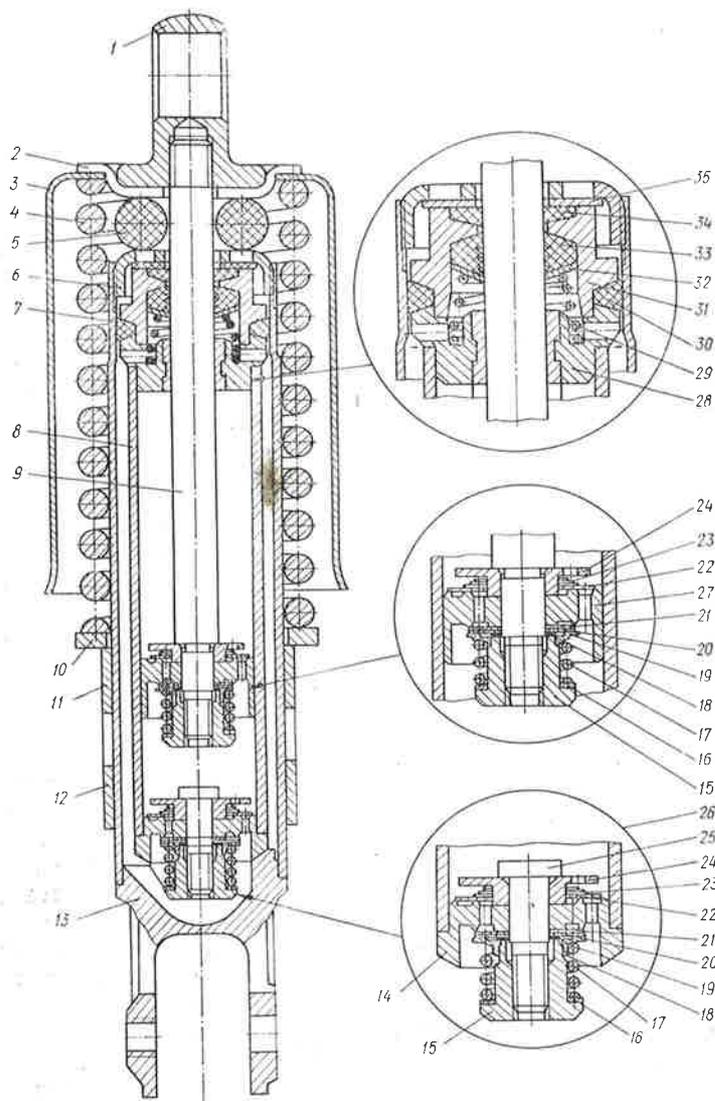
Рис. 26. Устройство амортизатора:
