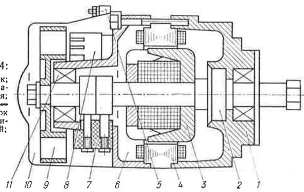
Рис. 35. Генератор Г424:
