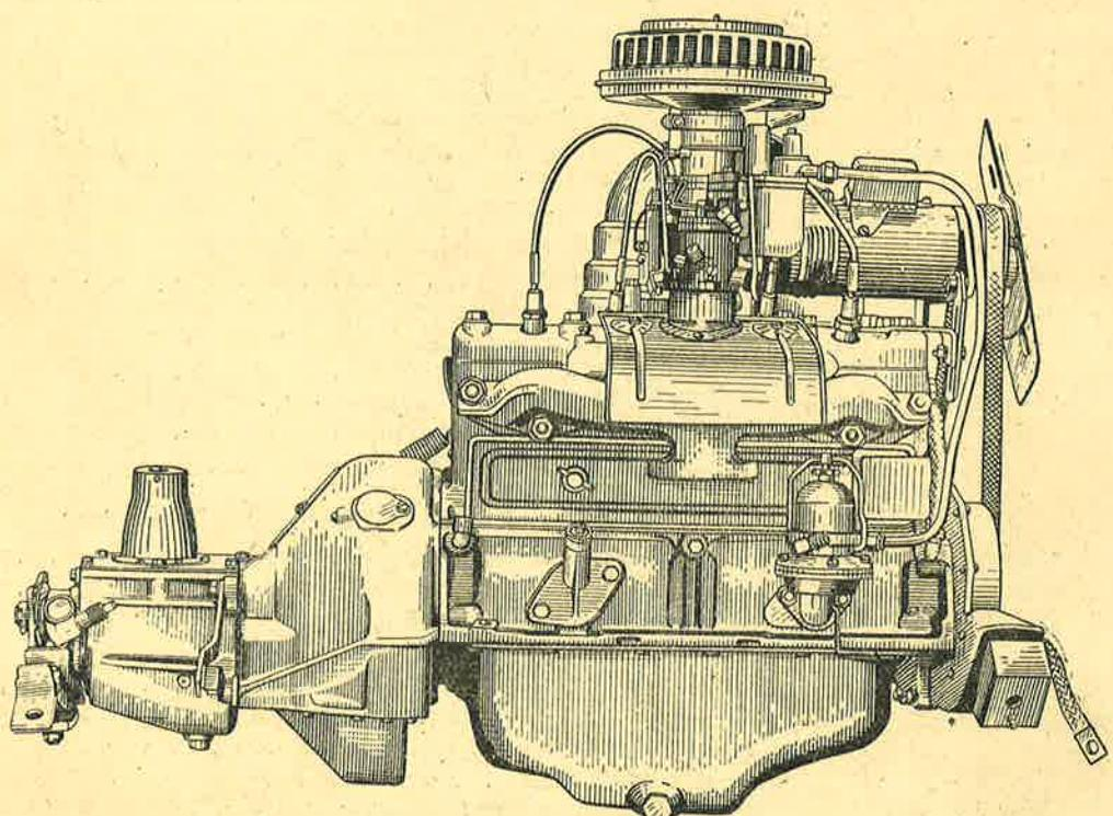
Фиг. 3. Двигатель автомобиля «Москвич» (вид справа).
