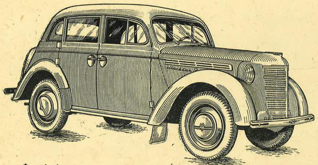
Фиг. 1. Автомобиль «Москвич» модели 400-420 с закрытым кузовом.
